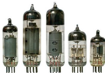
**Válvula de vacío:** Fueron los primeros componentes electrónicos que permitieron realizar operaciones lógicas sencillas. Juntando muchos de estos componentes se podían crear circuitos electrónicos y realizar operaciones más complejas, incluso un rudimentario ordenador.
